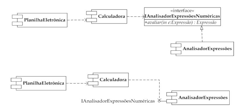
• Exemplo de diagrama de componentes embutido em um diagrama de implantação.
